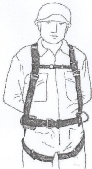
Fig. 14 - Imbracatura per il corpo con cintura di posizionamento integrata
